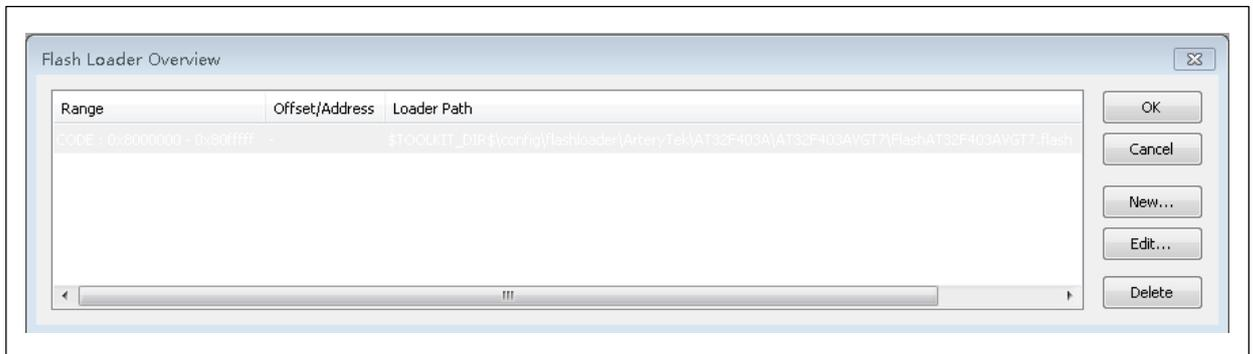
其中的flash算法配置方法是选定MCU芯片型号后默认指定，如需手动进行修改可点击旁边的New/Edit/Delete三个选项进行修改。
