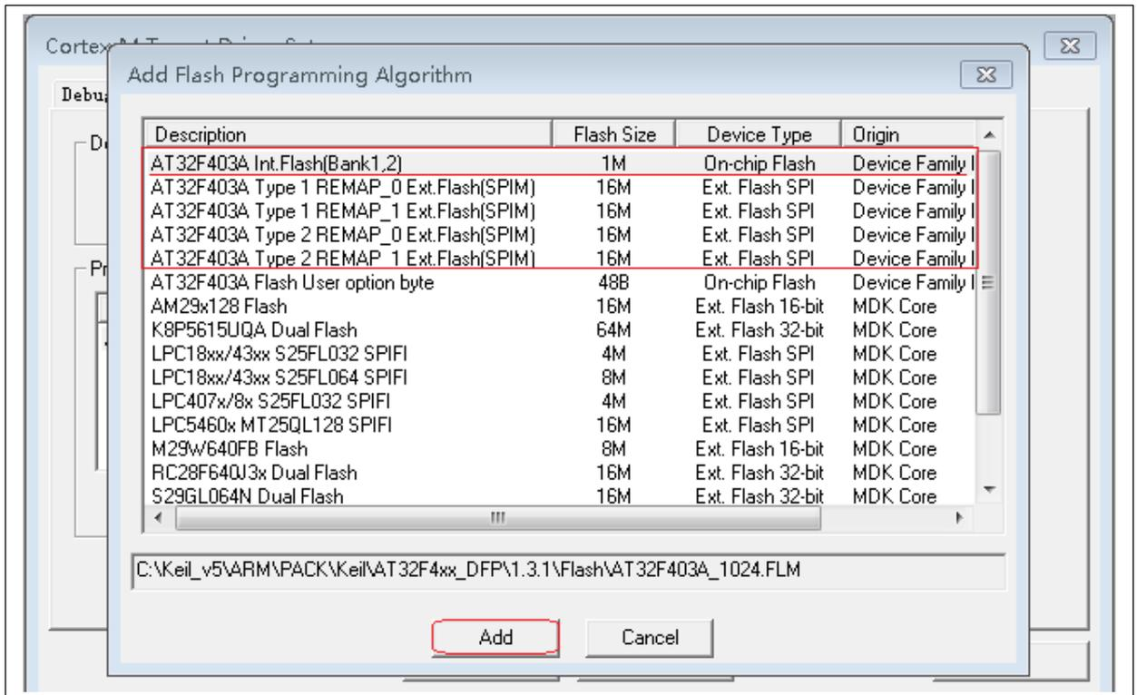
当选择到相应的算法文件后点击**Add**即可将新算法文件加入到当前工程配置，如下示例是新增SPIM算法到工程中：
