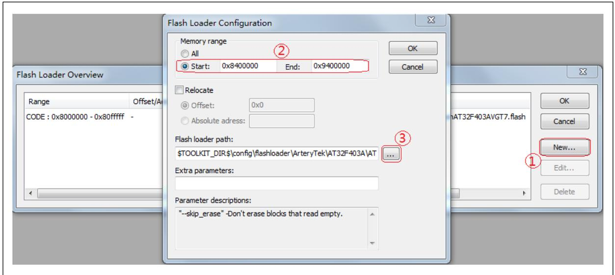
此处示例是新增SPIM flash算法文件举例。需选择对应型号且正确的Flash算法文件进行配置。被选择的flash算法配置文件是由IAR\_AT32MCU\_AddOn工具安装到IAR开发环境内。示例新增的SPIM flash算法完成配置后如下图：
