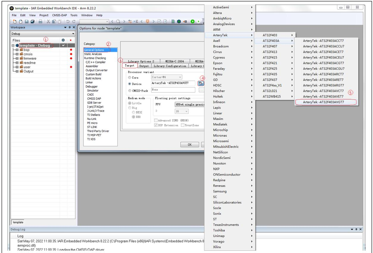
修改型号宏定义，操作步骤和图示如下：
