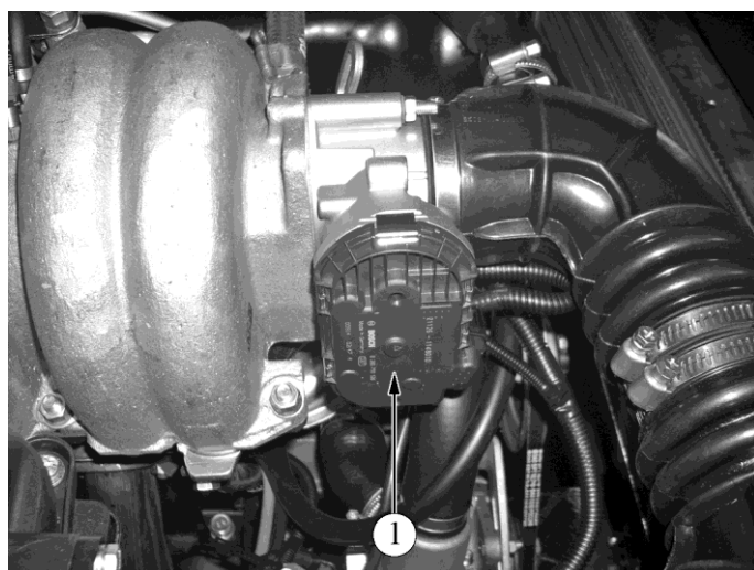
Рис. 1.7-04. Расположение дроссельного патрубка на а/м 21214:
