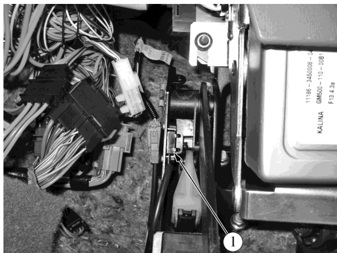
Рис. 1.1-22. Расположение ВСППС в салоне автомобилей семейства LADA KALINA:
