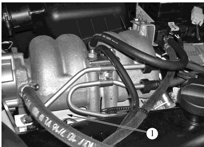
Рис. 1.3-12. Расположение рампы форсунок на двигателе 21214:
