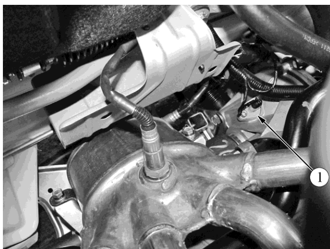
Рис. 1.1-14. Расположение датчика скорости в подкапотном пространстве автомобилей семейств LADA PRIORA и LADA KALINA:
