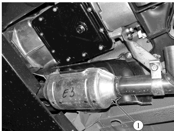
Рис. 1.9-02. Расположение каталитического нейтрализатора на автомобилях семейства LADA 4x4 (вид снизу):
