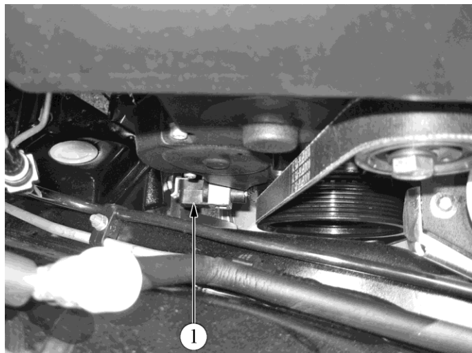
Рис. 1.1-16. Расположение датчика положения коленчатого вала в подкапотном пространстве автомобилей семейства LADA PRIORA:
