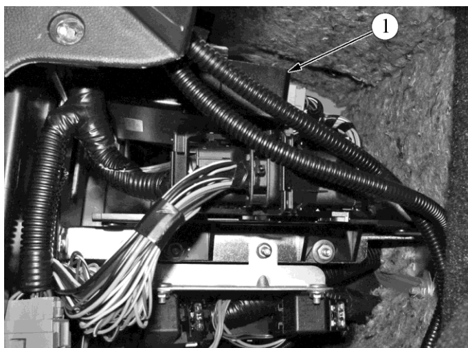
Рис. 1.2-02. Расположение контроллера электропакета в салоне автомобилей семейства LADA PRIORA:
