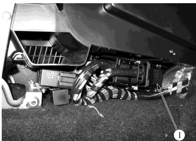
Рис. 1.1-02. Расположение контроллера в салоне автомобилей семейства LADA KALINA:
