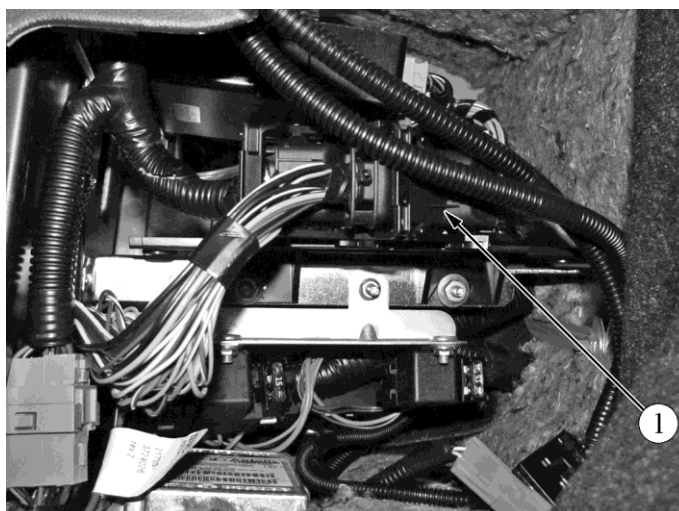
Рис. 1.1-01. Расположение контроллера в салоне автомобилей семейства LADA PRIORA:
