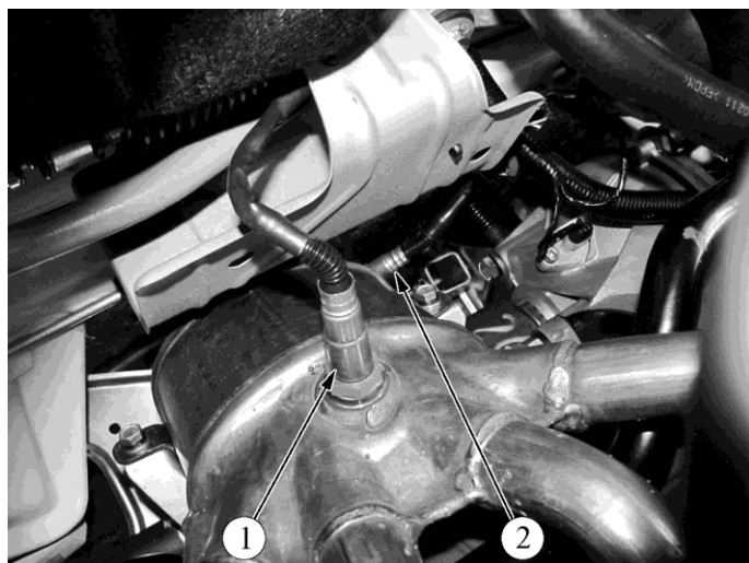
Рис. 1.1-12. Расположение управляющего и диагностического датчика кислорода в подкапотном пространстве автомобилей семейств LADA PRIORA и LADA KALINA:
