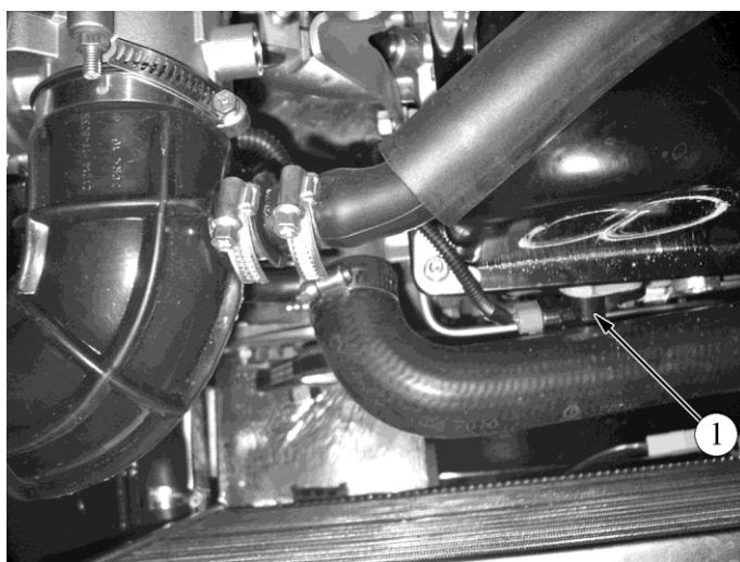
Рис. 1.1-19. Расположение датчика фаз на двигателях 21214:
