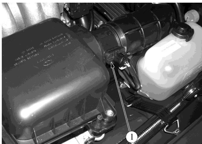
Рис. 1.1-05. Расположение датчика массового расхода воздуха в подкапотном пространстве автомобилей семейств LADA 4x4:
