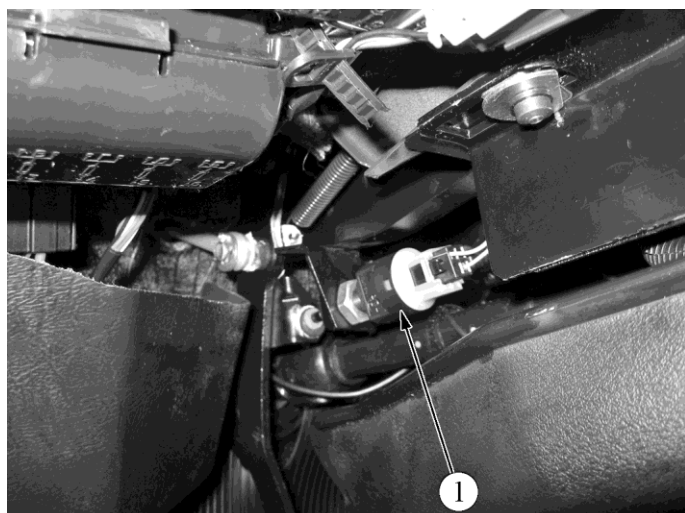
Рис. 1.1-23. Расположение ВСППС в салоне автомобилей семейства LADA 4x4:
