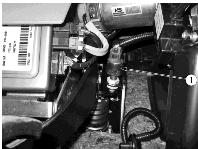
Рис. 1.1-20. Расположение выключателя сигнала торможения в салоне автомобилей семейства LADA KALINA:
