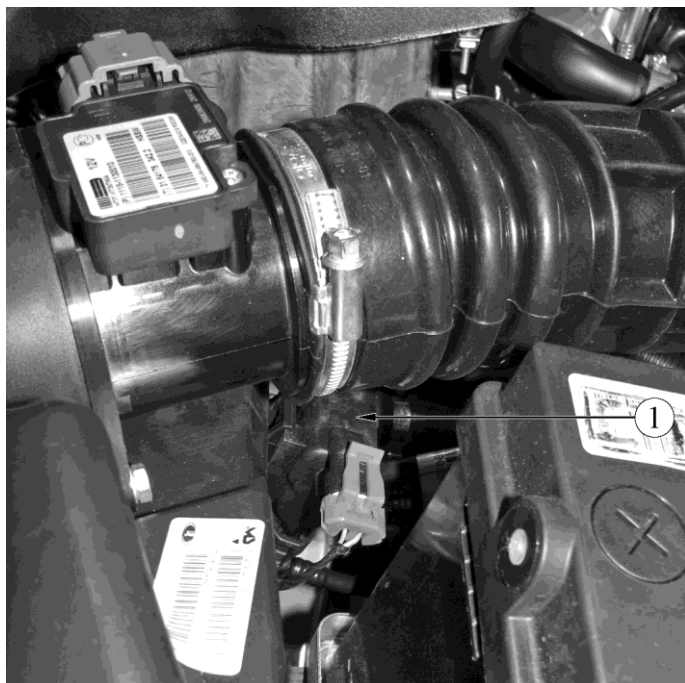
Рис. 1.8-02. Расположение клапана продувки адсорбера на автомобилях семейств LADA GRANTA и LADA KALINA 2:
