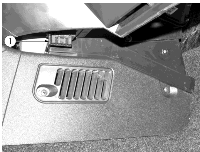
Рис. 2.3-01. Расположение колодки диагностики в салоне автомобилей семейств LADA GRANTA и LADA KALINA 2:
