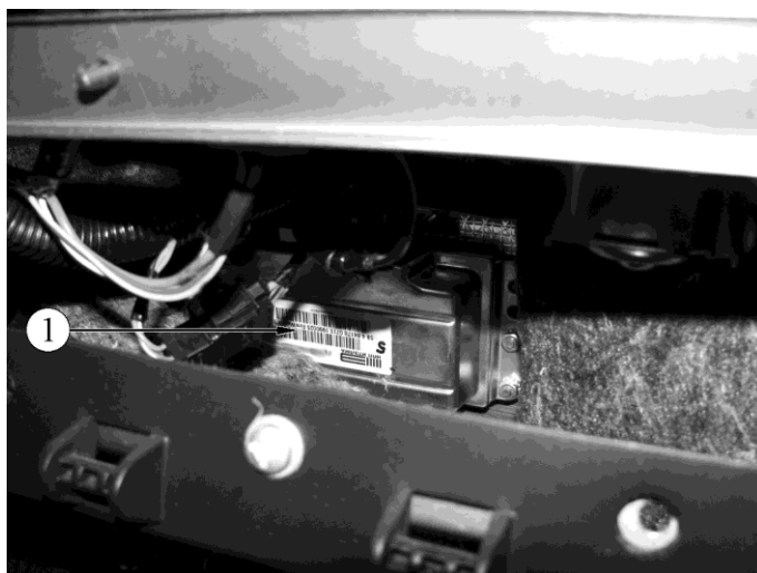
Рис. 1.1-01. Расположение контроллера в салоне автомобилей семейства LADA GRANTA и LADA KALINA 2:
