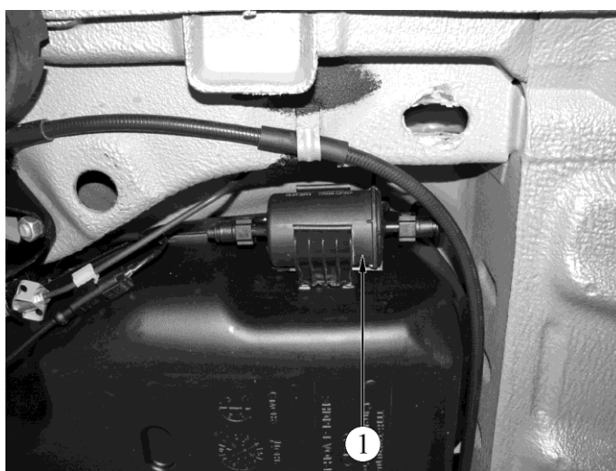
Рис. 1.3-03. Расположение топливного фильтра на автомобилях семейств GRANTA и LADA KALINA 2 (вид снизу):
