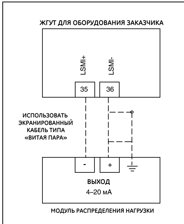
Рисунок 2.05-7: Внешний контроль нагрузки – модуль распределения нагрузок – 4–20 мА
