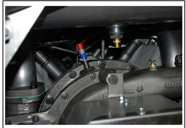
Рисунок 2.00-2: Датчик магнитных импульсов распределительного вала
