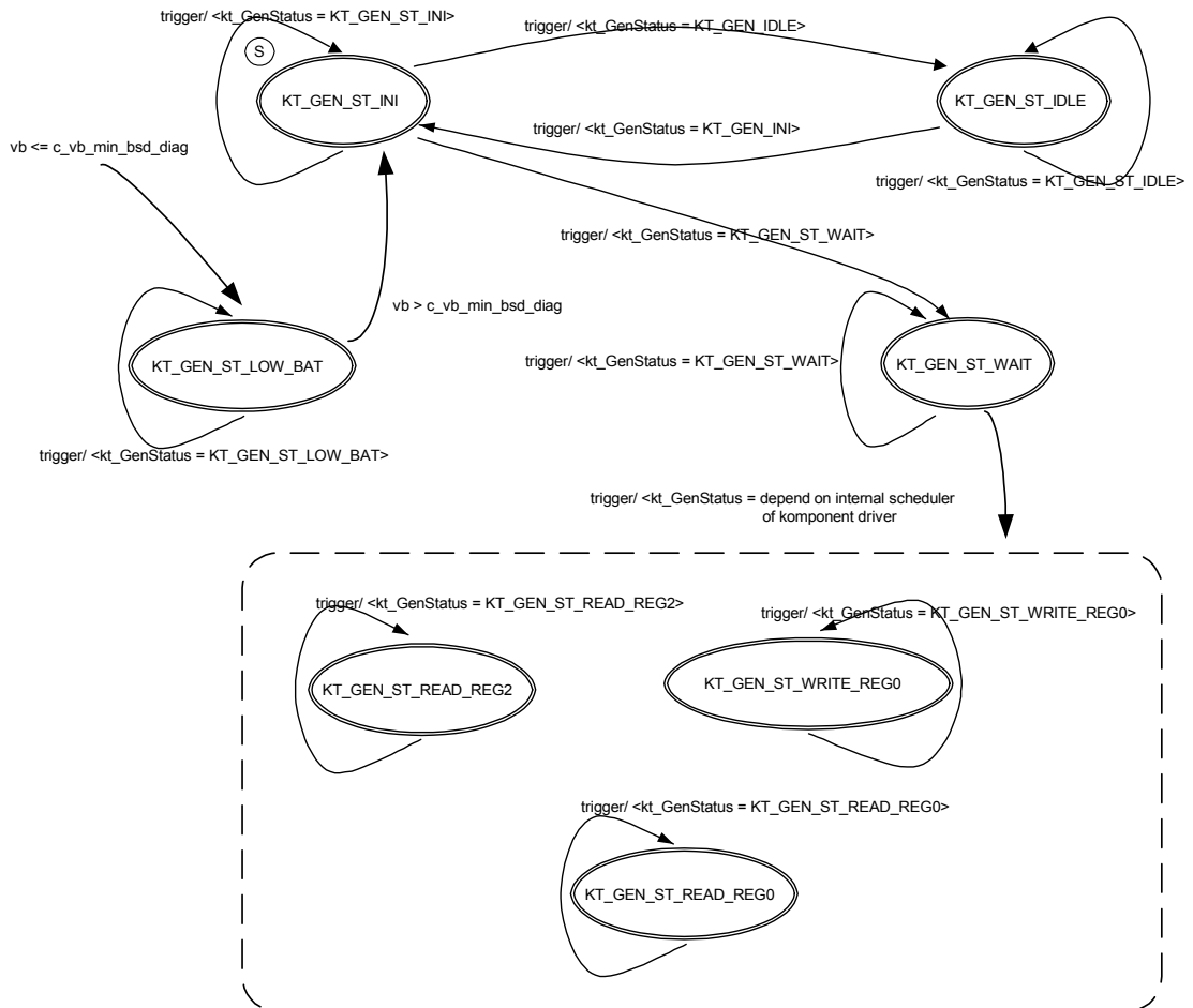
Abbildung 43.6-1: Statemaschine KT-Treiber Generator
