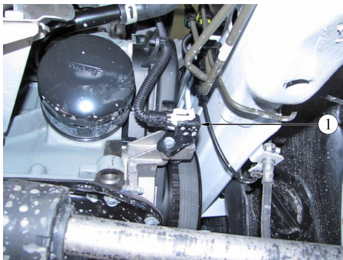
Рис. 1.1-07. Расположение датчика положения коленчатого вала на двигателе 21129:
