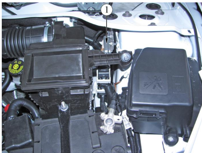
Рис. 1.1-01. Расположение контроллера в подкапотном пространстве автомобилей семейства LADA VESTA:
