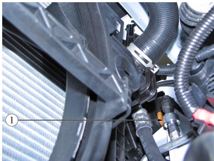
Рис. 1.9-02. Расположение датчика давления хладагента в подкапотном пространстве автомобилей семейства LADA VESTA:
