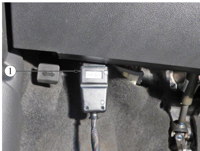
Рис. 2.3-01. Расположение колодки диагностики в салоне автомобилей семейства LADA VESTA:
