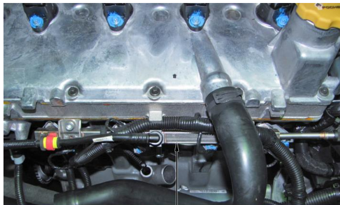
Рис. 1.2-04. Расположение ramпы форсунок на двигателе 21129 (модуль впуска снят):
